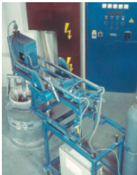
Schmelzebehandlung am Induktions-Tiegelofen.
