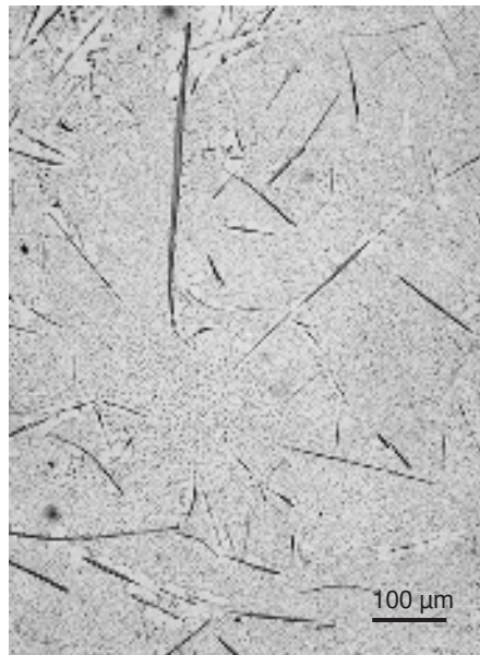
Abb. 13: Ansammlung von eisenhaltigen intermetallischen plattenartigen Phasen in überveredeltem AlSi12.
