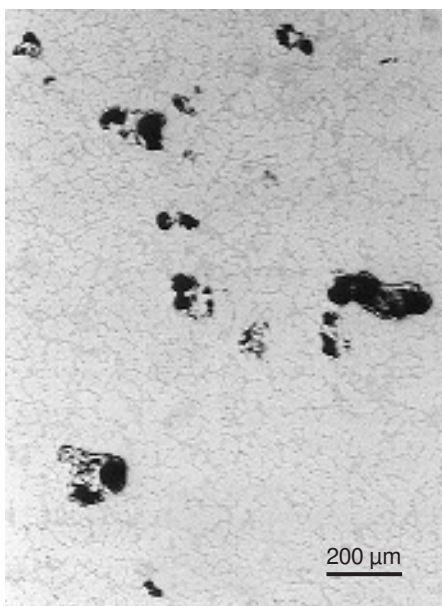
Abb. 2: Ansammlung von Oxidhäuten mit eingeschlossenen Gasblasen.
