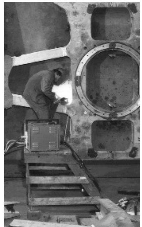
Abb. 1: Hauptquerträger für U-Bahn aus Alufont-52 warmausgehärtet zusammen mit Verbindungsprofilen in der schwenkbaren Schweißlehre.
