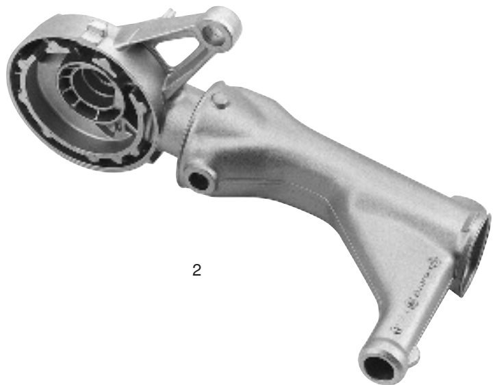
2 Radaufhängung für Motorrad Kippkokillenguß, dauerveredelt warmausgehärtet Maße: 640 x 300 x 140 mm Gewicht: 5,2 kg
