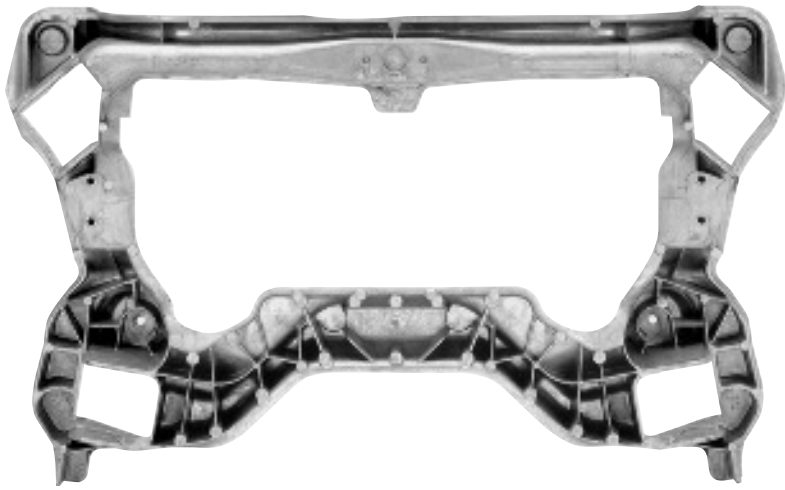
4 Integralträger Druckguß; Zustand O Maße: 920 x 580 x 170 mm Gewicht: 10,0 kg
