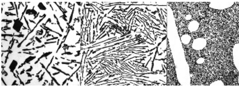
Abb. 1: Gefügemodifikationen des AlSi-Eutektikums: körnig, lamellar, veredelt.
