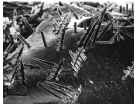
Abb. 1: Dendriten senkrecht zur Gußoberfläche wachsend.
