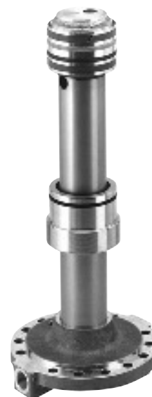
Abb. 2: Stoßdämpferbein für Einzelrad-Aufhängung an Schwerlastfahrzeugen mit einer druckdichten Verschweißung aus stranggepreßter Kolbenstange und gegossenem Kolben aus Anticorodal-70 warmausgehärtet.
