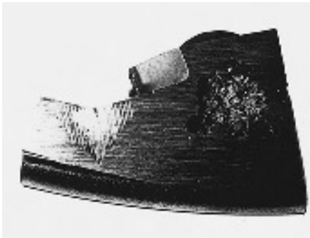
Abb. 8: Makrolunker, bestehend aus Mikrolunkern.
